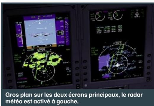
Gros plan sur les deux écrans principaux, le radar météo est activé à gauche.
