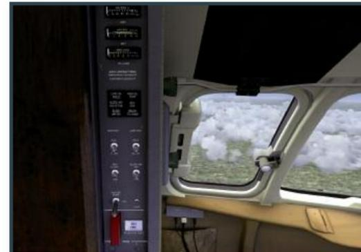
*Ci-dessus :* Les commandes de l'APU sont placées derrière le siège du pilote.
