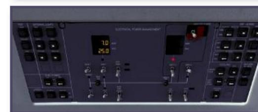
L'overhead : circuits électriques, feux, démarrage et air conditionné.
